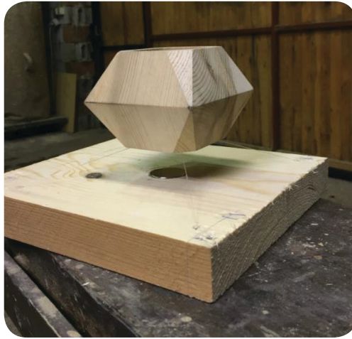
Slika 4: Prvi prototip za testiranje megnetov; vir: Luka Oblak
