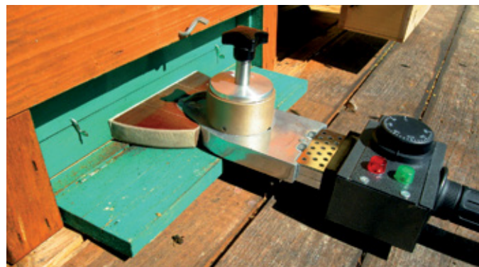
Tip sublimatorja z regulacijo temperature za optimalen proces sublimacije, ki je varen za delo ter ima certifikat CE.
