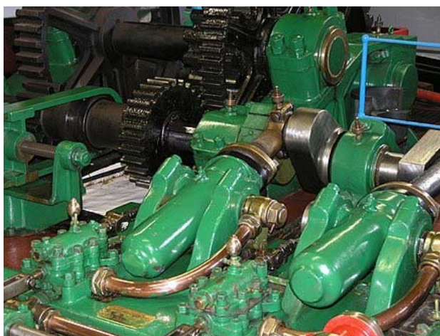
Slika 6 : Strojnica v vrtljivem delu mostu in detajl opreme (levo), ter načrt hidrauličnega pogonskega motorja (desno)
