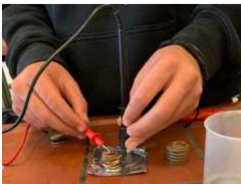
SLIKA 1: Sestavljanje Voltovega stolpa in merjenje napetosti.
