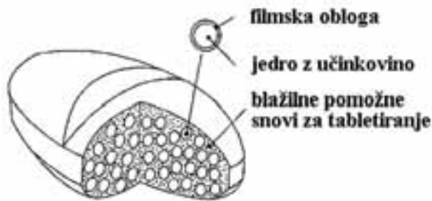
Slika 1: Shematski prikaz večenotne farmacevtske oblike – tablete stisnjene iz obloženih pellet (4).
