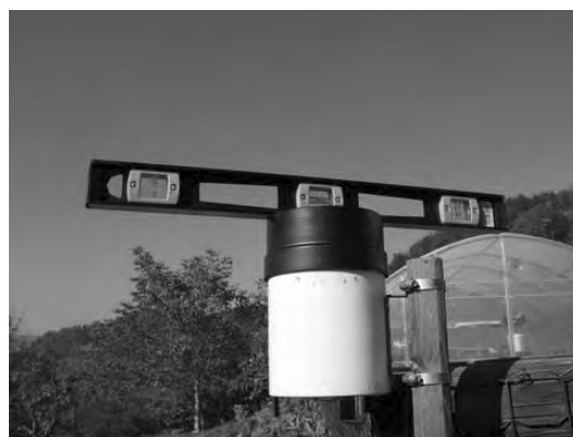
Slika 10: Dežemer številka 6 med postavljanjem
