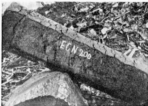
Slika 5 — prečna razpoka na kovaškem ingotu
