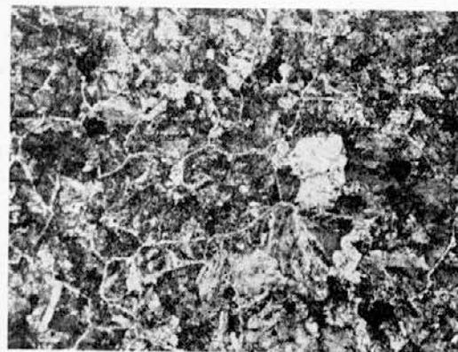
Slika 4 — jeklo Č 4320 (EC 80), Al cel 0,010%, Al top 0,002%, velikost zrna po ASTM 3, povečava 100×
