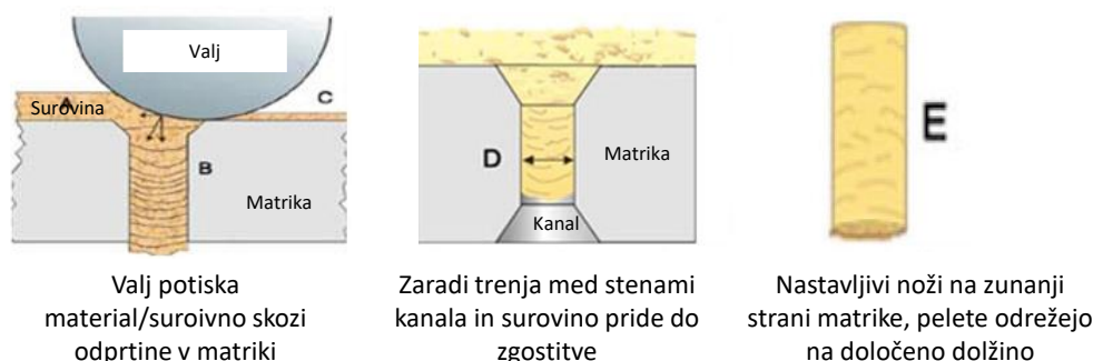
Slika 11: Mehanizem nastanka pelet.
