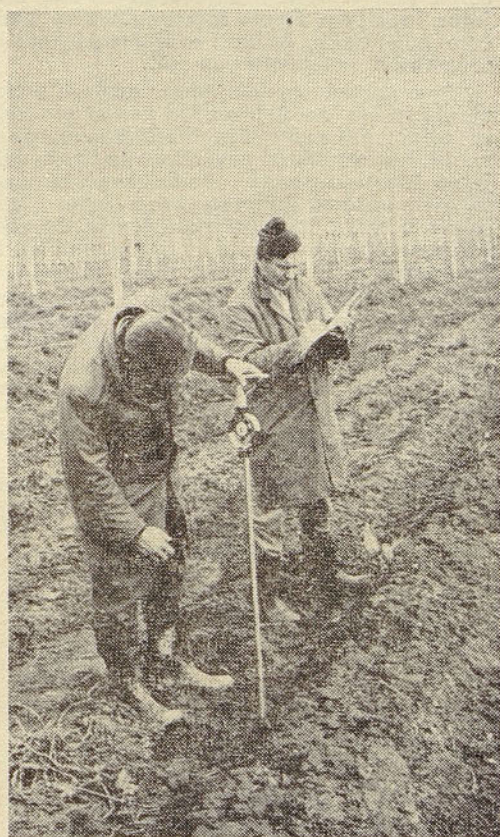
Ugotavljanje zbitosti zemlje v hmeljiščih, ki je posebno v kolesnicah, za neovirano rast korenin, prekomerno stisnjena
