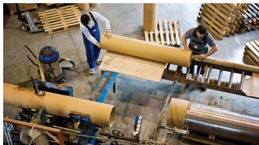
Razrez cevi na koncu navijalne linije. Cutting the tube at the end of the winding line.
