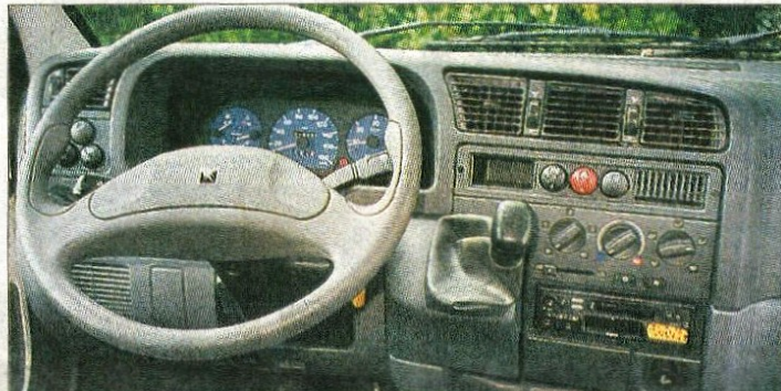
Za voznika: visoko sedenje, položen volan, nerodni obvolanski ročiči in pripravno kratka ročica menjalnika.
