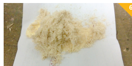
Kit, pripravljen iz lesnega prahu in belega lepila.
