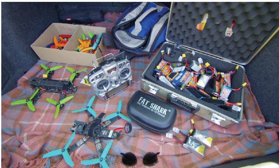
Običajen dirkalni komplet: kopica akumulatorjev in propelerjev, dva letalnika, RV-naprava in FPV-očala.
