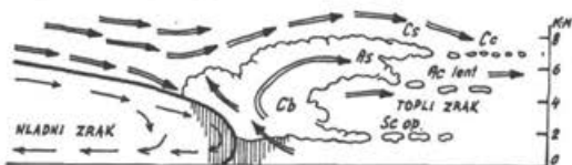
Sl. 4 – Vertikalni prerez hladne fronte (po T. Bergeronu)
