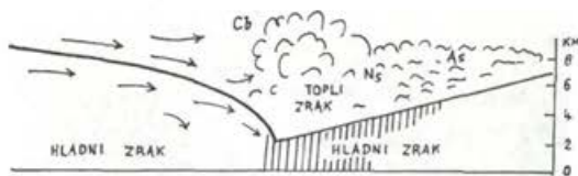
Sl. 5 – Vertikalni prerez okluzijske fronte (po Bergeronu)
