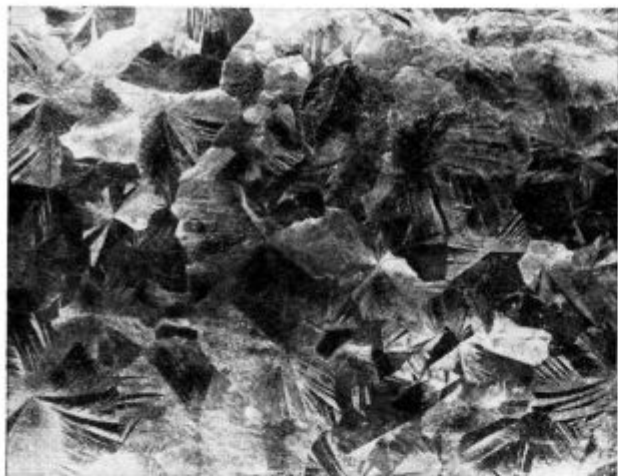
Slika 15 Izgled kristalov ob dodatku 0.15 Al
