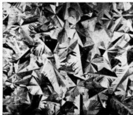
Slika 21 Videz kristalov prevleke hladno valjane pločevine
