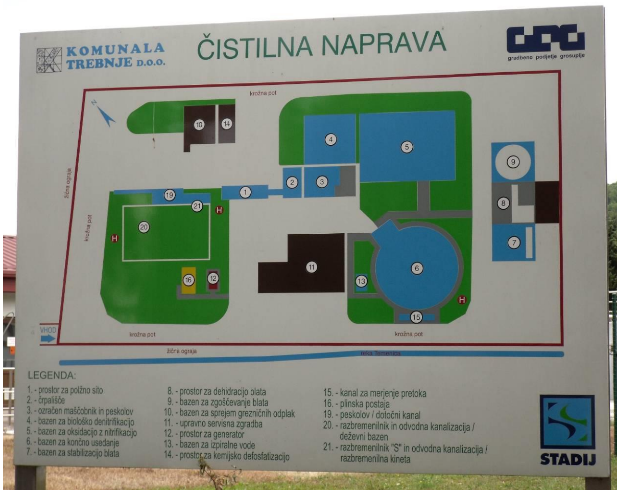
Shema čistilne naprave Komunalne Trebnje (avtor fotografije: Helena Fortuna)
