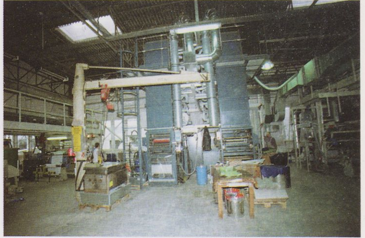
Dva najnovejša stroja, ki bosta že čez nekaj tednov izdelovala po sto tekočih metrov folije na minuto. Proizvodnja teče neprekinjeno v treh izmenah.
