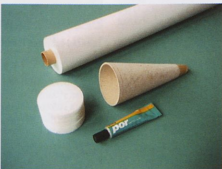
Slika 5. Konus in vsadilo glave iz ploščic deprona pred sestavljanjem.
