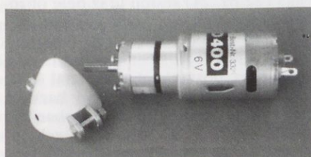
Slika 4. Motor speed 400 z nameščenim zobniškim planetnim reduktorjem, katerega pglavitna prednost je, da ne pride do zamika med osjo reduktorja in osjo motorja.
