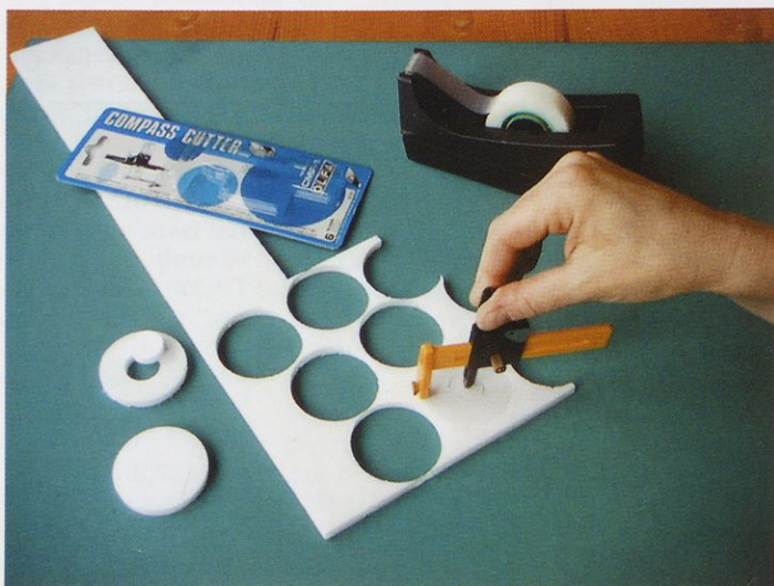
Slika 2. Olfin compass cutter je izvrsten pripomoček za izrezovanje krogov in kolobarjev iz deprona.
