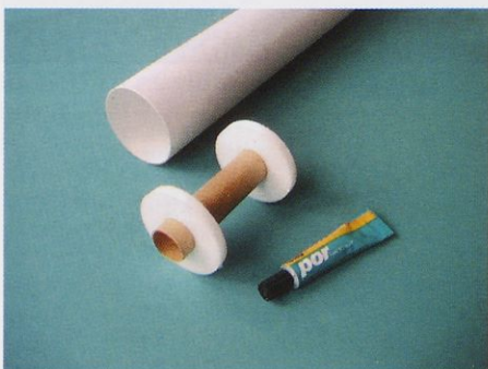
Slika 4. Takšen je nosilec motorja, če model nima ladijskega repa.
