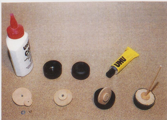
Slika 8. Prikaz izdelave koles po posameznih stopnjah (od leve proti desni)
