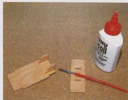
Slika 7. Ker so stične površine majhne, lepilo nanašajte z majhnim čopičem.
