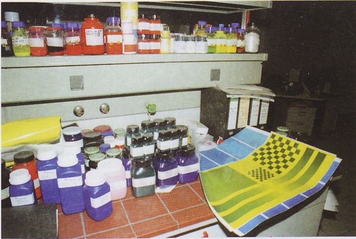
Na fotografiji vidimo nekaj preizkušancev, namenjenih razvoju novih barvnih vzorcev in kombinacij. Posebno pozornost posvečajo vplivu osnovne barve na odtenek naslednjega nanosa.
