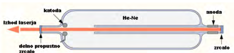
Slika 3: Princip delovanja HeNe laserja.
