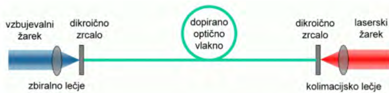
Slika 6: Princip delovanja vlakenskega laserja.
