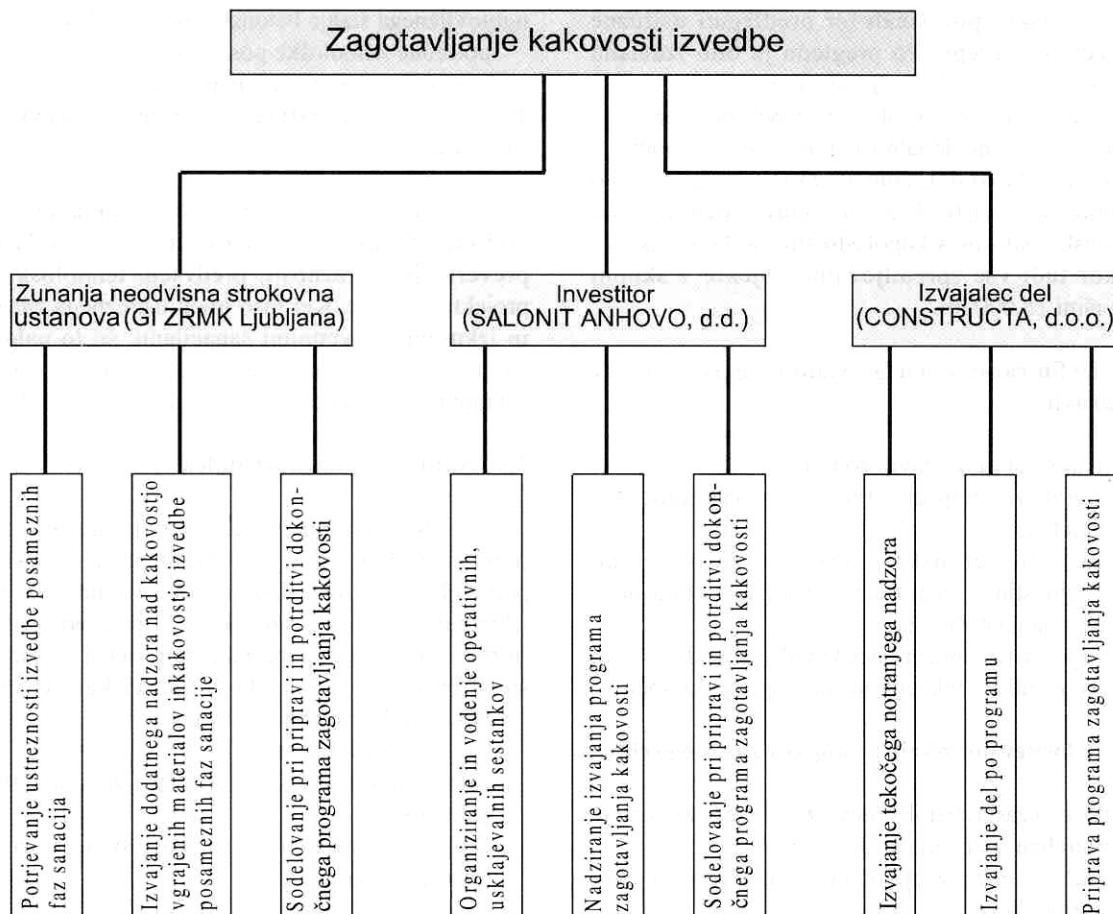
Sl. 3. Model obvladovanja kakovosti pri sanaciji armirano betonskih silosov
