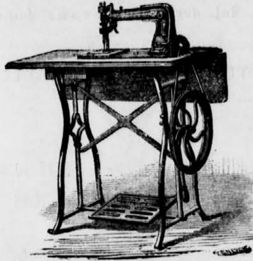
Neue Nr. 7 Maschine mit gerader Nadel. Für schwere Schneider- und Lederarbeit mit allen nötigen Apparaten ö. W. fl. 85.—.
