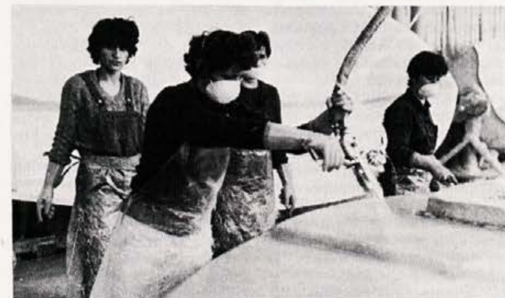
Strojno nanašanje steklenih vlaken na čolne
