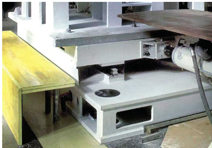
Slika 15 • Potresna miza na ZAG s programskim hidravličnim batom za pogon mize; vidi se tudi eno od drsnih vodil
