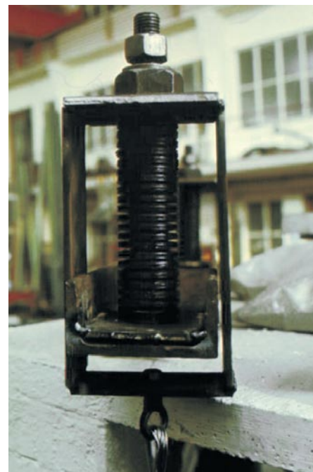
Slika 10 • Pri enostavnem modelu zahtevana napetostna razmerja ustvarimo s prednapetjem zidov. Silo vnašamo z mehkimi vzmetmi
