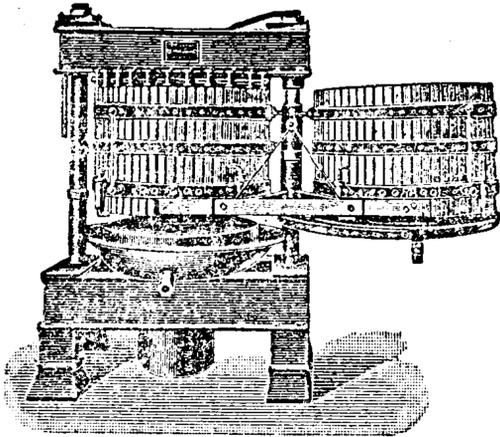
mit Oberdruck Patent „Duchser“, für Handbetrieb
