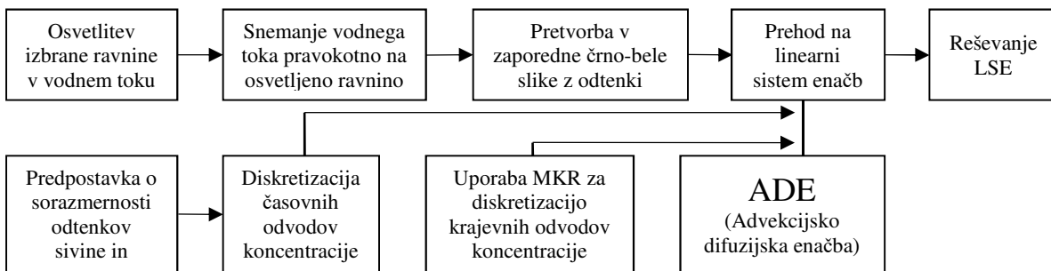
Slika 1: Shema poteka določitve hitrostnega polja
