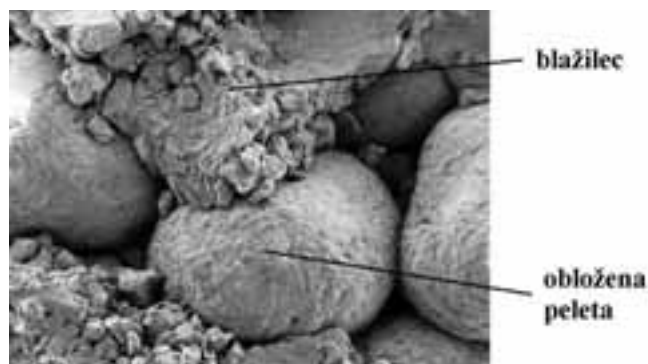
Slika 4: Prelom tablete stisnjene iz zmesi obloženih pelet in blažilne pomožne snovi.
