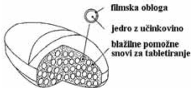
Slika 1: Shematski prikaz večenojne farmacevtske oblike – tablete stisnjene iz obloženih pelet (4).
