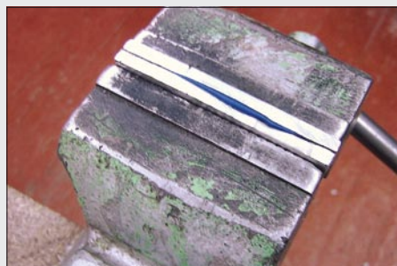
Po segrevanju na plošči štedilnika kalup previdno stisnemo v primežu.
