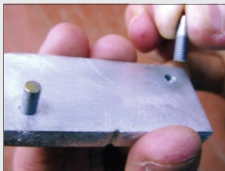
V izvrtine v spodnjem delu kalupa vstavimo centrirne čepa.
