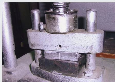
Obe polovici kalupa skupaj s pramodelom močno stisnemo s pomočjo knjigoveške preše, da se stični ploskvi popolnoma poravnata.
