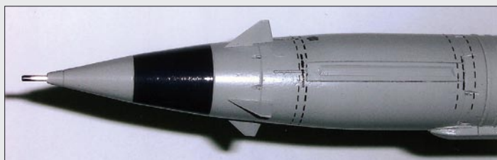
Maketa protiletalske rakete 5JA23 (SA-2) v merilu 1 : 25 z označnimi detajli, izdelanimi iz toplotno preoblikovanega polistirena. Po tem postopku izdelane dele makete rakete SA-2 odlikujejo gladke površine, ostri robovi in natančni prehodi.
