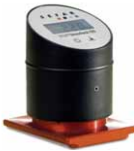
Merilni instrumenti za vrednotenje napetosti sita in vlažnosti kopirnega sloja.
