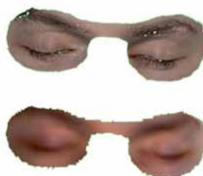
Slika 4: Teksturirana mreža na področju oči, pridobljena s skenerjema LabodScan (zgoraj) in Sense (spodaj).
