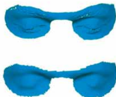
Slika 3: Obarvana mreža na področju oči, pridobljena s skenerjema LabodScan (zgoraj) in Sense (spodaj).
