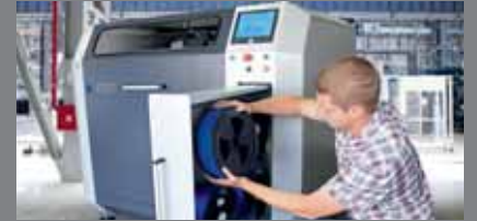
3D-tiskalnik Rep Rap X 1000 V2 je sistem nepretrganega 3D-tiska v novi večji preobleki: nitko v navitju lahko zamenjamo kar med 3D-izpisovanjem.
