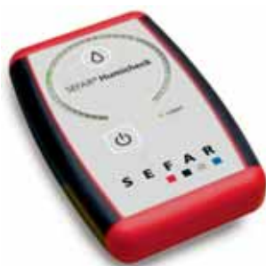
Merilni instrumenti za vrednotenje napetosti sita in vlažnosti kopirnega sloja.
