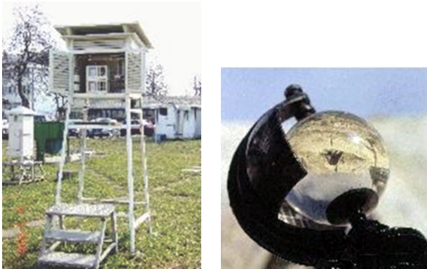
Sliki 5 in 6: Meteorološka postaja in instrument za merjenje trajanja sončnega obsevanja (heliograf) (Vir: https://ciklon.si/stran/?p=22664 )
