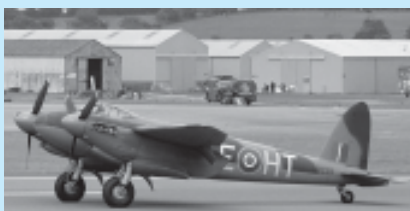
□ Slika 4. Med lesena letala spada tudi izjemno uspešno dvomotorno bojno letalo De Havilland MOSQUITO, ki so ga zgradili Angleži med zadnjo svetovno vojno. Sklepamo lahko, da je bil eden od razlogov za uporabo lesa izogibanje sovražnikovem radarjem. Njegovo gradnjo so omogočila takrat razvita sintetična lepila (foto Marko Malec).
