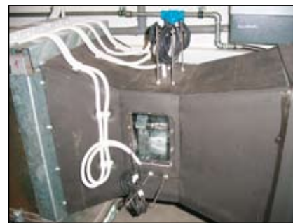
Slika 4a. Merilna proga LPT – detajli kanalskega dela: izstopna mreža tipal, merjeni PT in vstopna mreža tipal (smer zraka je iz desne proti levi)
