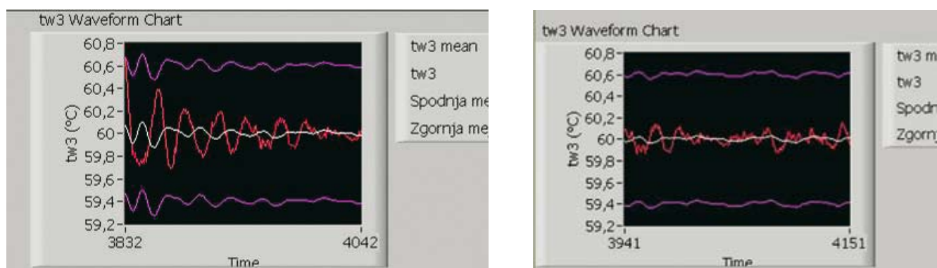
Slika 5. Umirjanje temperature vode v merjenem prenosniku toplote po začetnem zanihanju (regulacijski ventil)
