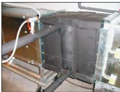
Slika 4a. Merilna proga LPT – detajli kanalskega dela: izstopna mreža tipal, merjeni PT in vstopna mreža tipal (smer zraka je iz desne proti levi)
