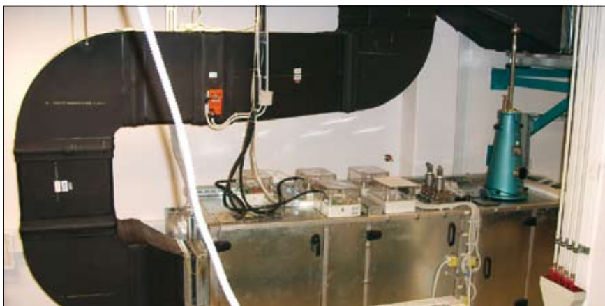
Slika 4b. Merilna proga LPT: merilna pretočna komora za merjenje pretoka zraka z vgrajenimi šobami
