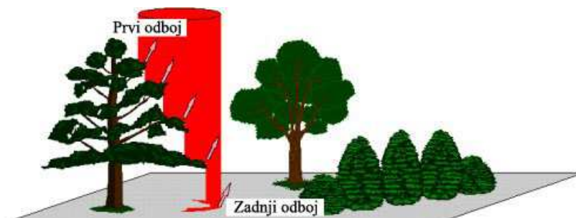
Slika 3: Več odbojev enega laserskega žarka na drevesu (TopoSys, 2007).
