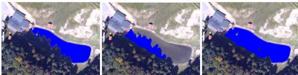
Slika 88: Od leve proti desni: klasifikacija vode iz BDOF1; klasifikacija vode iz lidarskih podatkov; združeno. Fig. 88: From left to right: classification of water from DOF; classification of water from lidar data; fusion.
