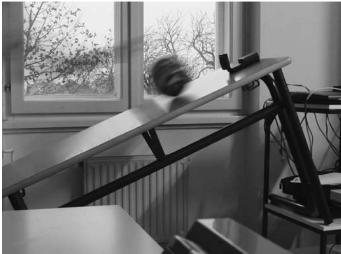
Slika 1. Postavitev poskusa s kotaljenjem žoge.
