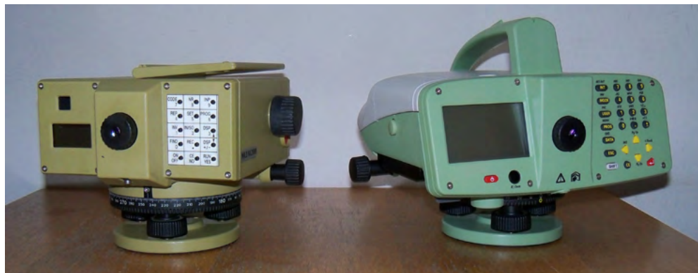
Slika 1: Dve generaciji nivelirjev: digitalni nivelir Leica NA2000 (levo) in DNA03 (desno), foto N. Tuno
