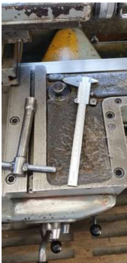
SLIKA 8: Merilno orodje iz reciklirane zlitine na šoli.
