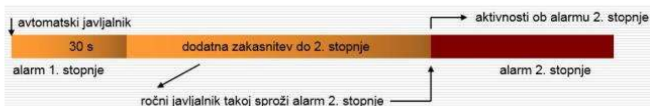
SLIKA 4: Protokol v primeru aktiviranja požarne centrale.
