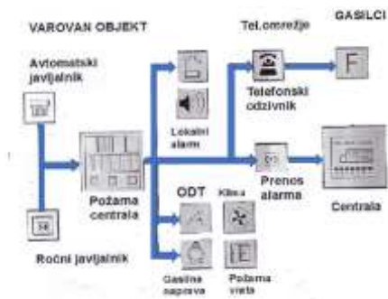
SLIKA 6: Osnovni elementi aktivne požarne zaščite.
