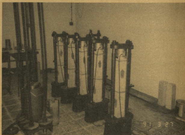
Slika 2: Jarmi za preiskave lezenja betona z vpetimi preizkušanci
