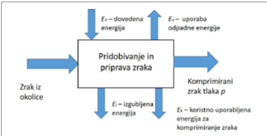
Slika 3. Energijska bilanca podsistema za pridobivanje zraka
