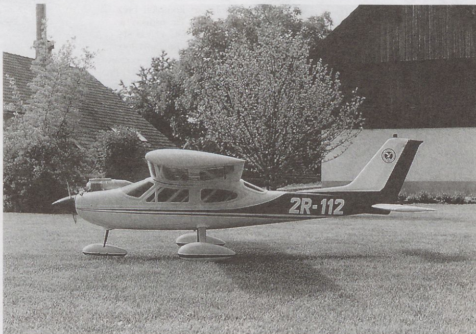
Model letala cessna 177 mini cardinal, pri katerem je na repu vgrajena pozicijska luč
