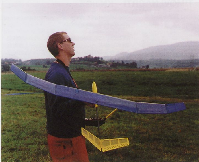
Kje leti konkurenca? Boštjan Čač (MD Albatros) pred metom modela lastne konstrukcije. Lepa je labka gradnja višinskega krmila iz balze.
