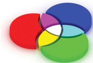
Slika 71: Seštevalni barvni model RGB
