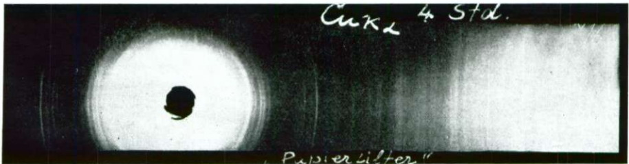
5. sl. Mežica, 7. obzor revirja Graben, zahodno od izvoznega jaška. Debye-Scherrerjev praškast diagram minija. Preparat je imel prečnik 0,5 mm, odprtina zaslonke je bila 1 mm, žarčenje s \text{CuK}\alpha , trajanje osvetlitve 4 ure s papirnim filtrom
