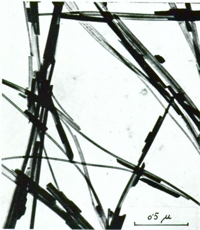
2. sl. Elektronski mikroposnetek stragarskega azbesta pri 45.900-kratni povečavi Fig. 2. Electron microscope picture of the Stragari-asbestos, 45.900 diams.
