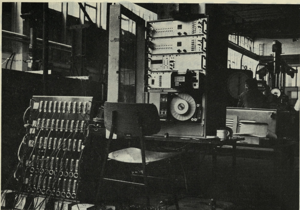
Slika 2. Naprava znamke Hottinger-Baldwin-Mess-technik tip UPH 300 za izvedbo meritev na 200 merskih mestih
