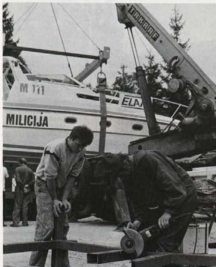
Izdelava nosilne konstrukcije
