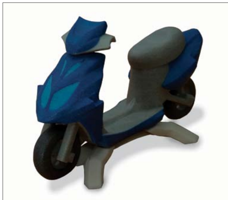
Na barvnem 3D-tiskalniku Spectrum Z510 natisnjen skuter Spear. Model je v merilu 1 : 10.
