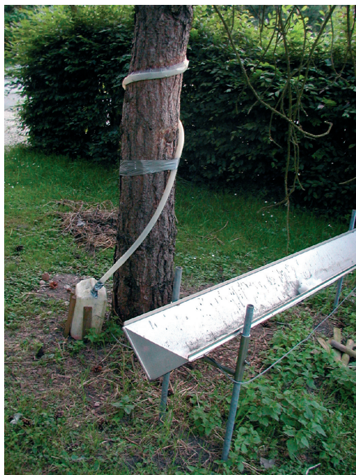
Slika 4. Merjenje odtoka po deblu (levo breza, desno bor) Figure 4a: Stemflow measurement (left Betula pendula Roth., right Pinus sylvestris L.).
