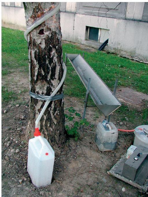
Slika 4. Merjenje odtoka po deblu (levo breza, desno bor) Figure 4a: Stemflow measurement (left Betula pendula Roth., right Pinus sylvestris L.).
