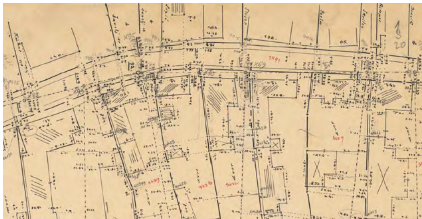
Slika 4: Izrez iz originalne skice ortogonalne izmere detajla v sistemu Gellerthegy. Skupaj je v k. o. Tešanovci in k. o. Suhi vrh 149 listov detajlnih skic. (Arhiv OGU MS, 2013)
