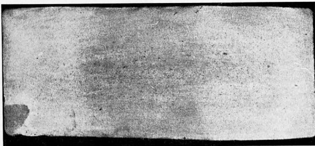
Slika 2 — jedkalna plošča odkovka ploščate palice 250 x 100, C 45. Opazne so majhne vzporedne razpoke, ki so lahko kosmiči ali pa razpoke z makro vključki
