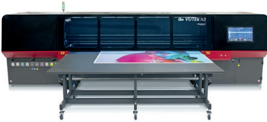
Novo serijo tiskalnikov Vutek h sestavljata model h3, ki izpisuje kapljično trilinijsko z velikostjo kapljic barvila sedem pl, in h5, ki izpisuje petlinijsko (na sliki model Efi Vutek h3).
