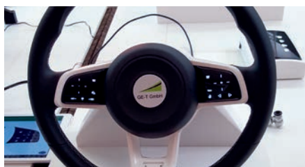
Slika 8: Prikaz uporabe tiskane elektronike na multifunkcijskem volanu avtomobila.
