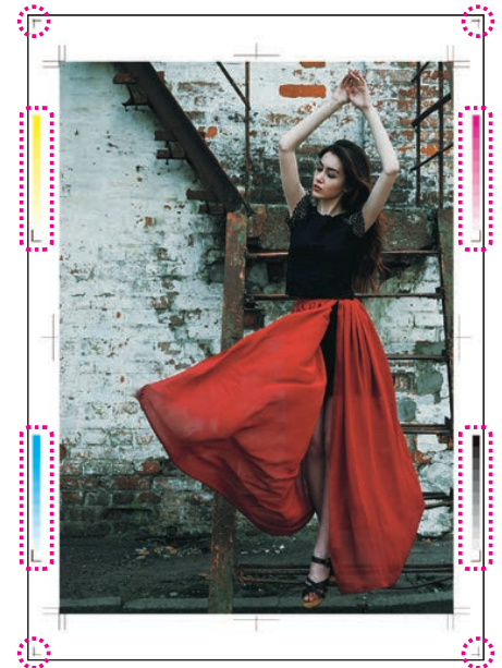
Samodejno izpisovanje, skeniranje in analiza obojestranskega skladja in gradacijskih merilnih polj.
