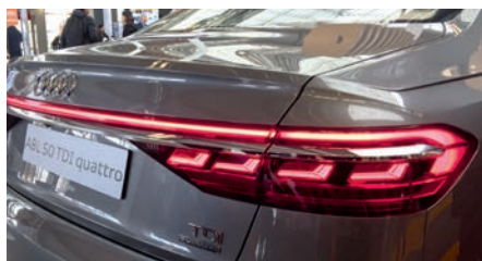
Slika 7: OLED-luči, ki omogočajo izjemno homogeno osvetlitev, na zadnjih avtomobilskih lučeh Audi A8L.
