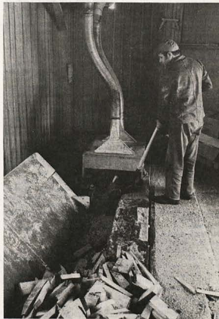
Drobljenje lesnih odpadkov za dodatni vir energije
