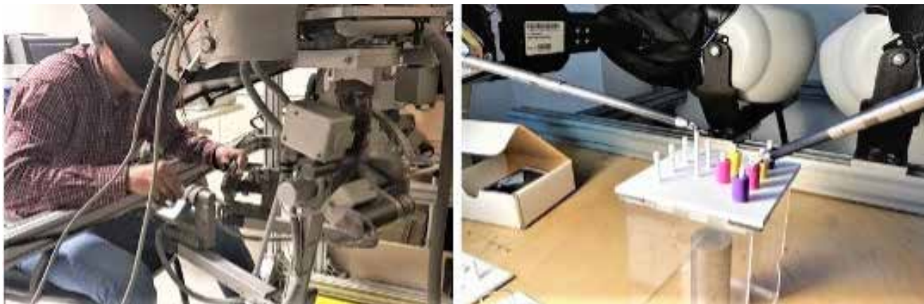
Slika 1: Da Vincijev raziskovalni komplet (dVRK), ki ga ponuja Inštitut BioRobotics – SSSA (Pontedera, Italija). Na levi sliki: glavna konzola dVRK, kjer operater med operativnim mestom v 3D-pregledovalniku operativno nadzoruje instrumente. Na desni sliki: pomožne roke, ki reproducirajo gibe operaterja.
