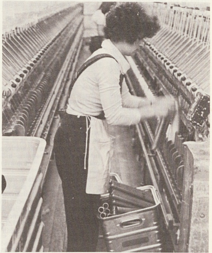
Hitre in spretne roke snemajo polne navitke preje s prstančnega stroja in natikajo prazne cevke. Paziti pa je potrebno, da se zabojček na vodilu ne zatakne in pade z vozička ziroma da delavka ob tem ne pade čez zabojček.
