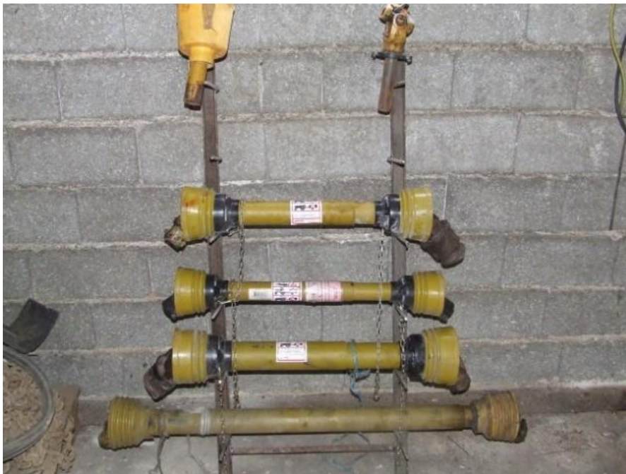
Slika 21 Pravilno zaščitena kardanska gred Vir: traktor.mojforum.si
