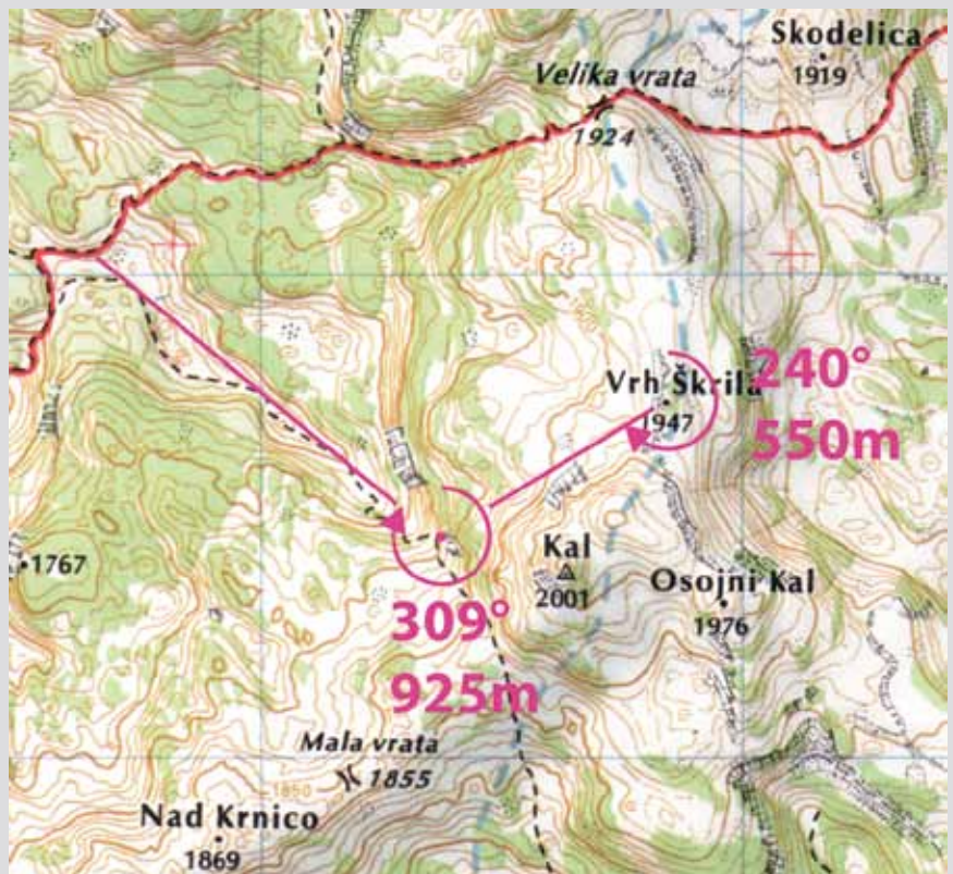
Slika 1: Primer: Z Vrha Škrila želimo priti do stezice in v območju stezice do markirane poti. Ker so poti pod snegom in je megla, se odločimo za hojo po azimutih. Iz karte izmerimo kote in razdalje. Prvi odsek poteka v smeri 240° in je dolg 550 metrov. Drugi odsek pa poteka v smeri 309° in je dolg dobrih 900 metrov.
