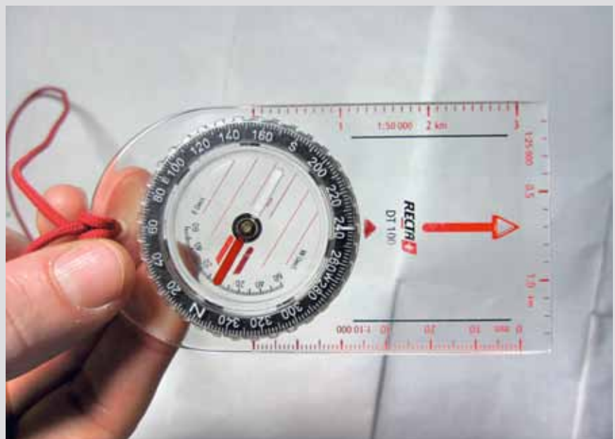
Slika 3: Izmerjeni kot na karti nastavimo na kompasu. Celotni kompas vrtimo, tako da se označba severa na vrtljivem delu kompasa in magnetna igla poravnata. Smer naše hoje je v smeri, ki jo kaže puščica na podstavku oz. ohišju kompasa. FOTO: BLAŽ GRAPAR
